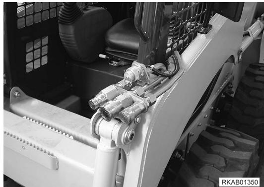
Усиленный поток масла к оборудованию подается по реверсивному контуру, регулируется с помощью педали (A) (см. 3.3.5 пункт 4 - ПЕДАЛЬ УПРАВЛЕНИЯ ДОПОЛНИТЕЛЬНЫМ КОМПЛЕКТОМ ГИДРАВЛИЧЕСКОГО ОБОРУДОВАНИЯ (ПРИ НАЛИЧИИ)) и соразмерен приложенному к педали усилию. Гидравлические магистрали и электрические кабели размещены с левой стороны погрузочной стрелы.
