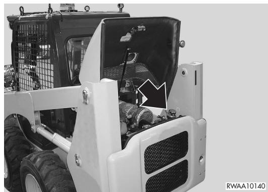
Остановив машину на твердой и ровной горизонтальной площадке, опустите рабочее оборудование на грунт, остановите двигатель и, несколько раз переместив органы управления, сбросьте остаточное давление в контуре рабочего оборудования.
