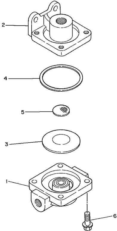
KEY NO. 1 - 6 VALVE ASSY-QUICK RELEASE (ASSY KEY NO.200)
