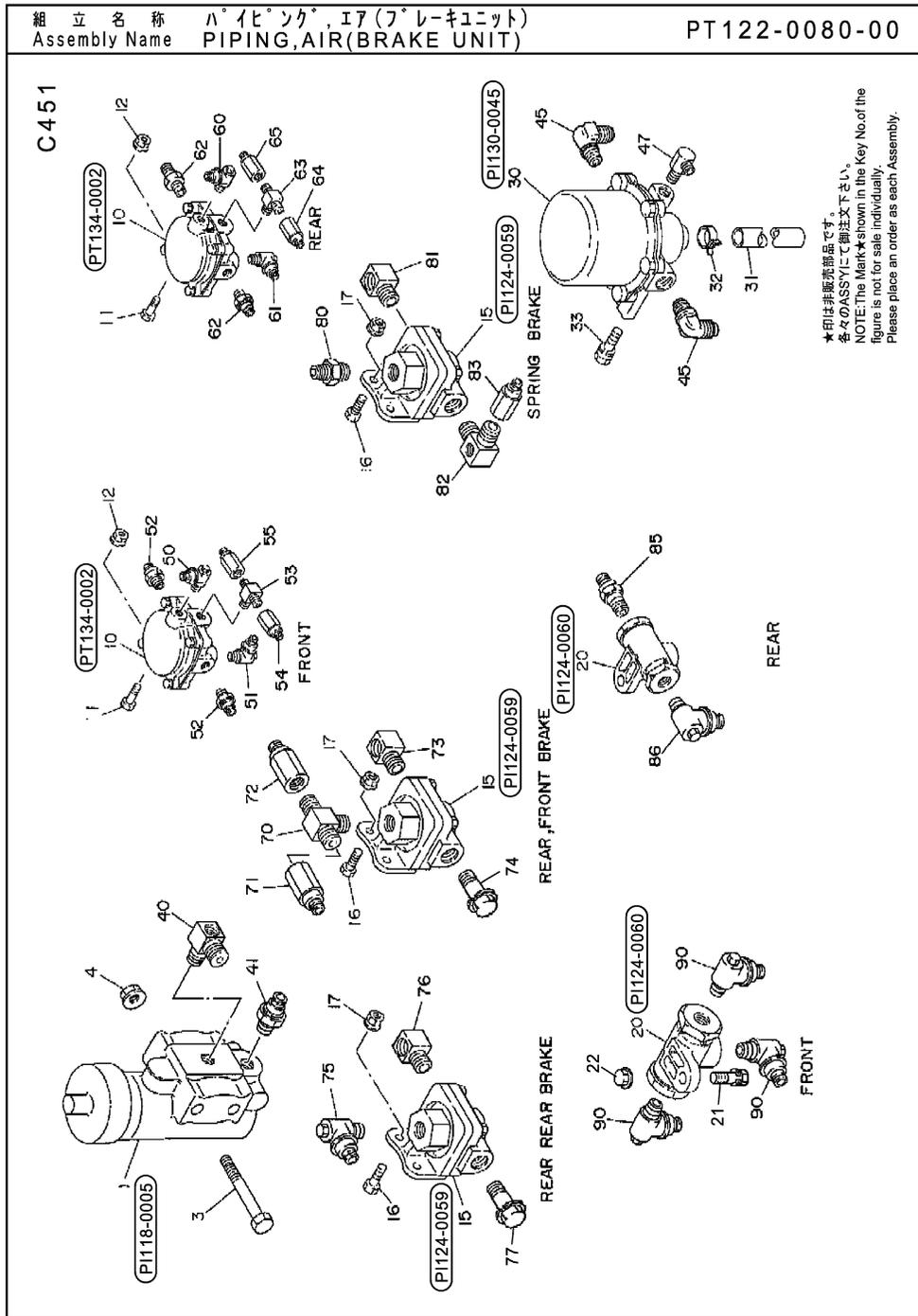
組立名称 ハイピンク、エア (ブレーキユニット) Assembly Name PIPING,AIR (BRAKE UNIT) FIG. PT122-0080-00
