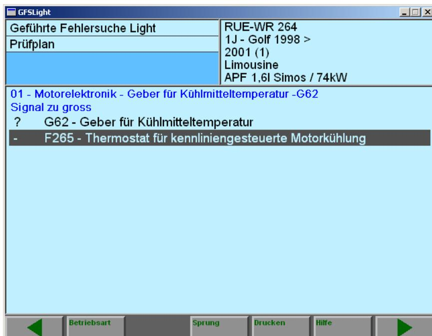
Bild 4-5 Reproduzierter Prüfplan aus Logbuchdaten
